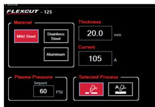
– **Gestion du procédé** – tous les paramètres sont contrôlés à partir de l'interface en fonction du **simple choix du matériau et de l'épaisseur** simplifiant la mise en œuvre de la découpe plasma. Plusieurs fonctions augmentent la productivité du cycle et compensent automatiquement l'usure des consommables.
