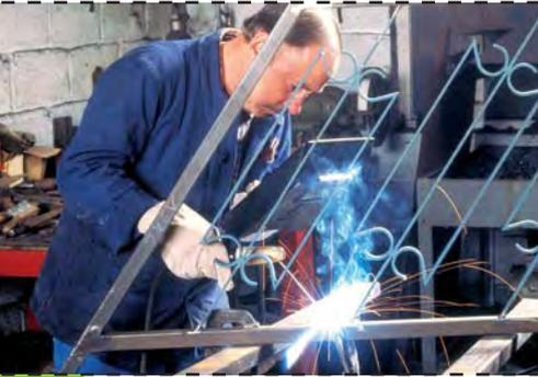
Ce procédé implique la création d'un arc électrique fourni par un générateur de courant (poste à souder) entre d'une part la pièce à souder et d'autre part une électrode. L'électrode est en fait une baguette métallique conductrice du courant électrique. A son extrémité jaillit un arc électrique qui apporte l'énergie calorifique nécessaire à la fusion des pièces à assembler.
