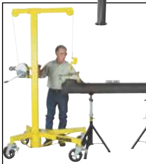
Positionner les raccords avec Adjust-A-Fit Sumner
