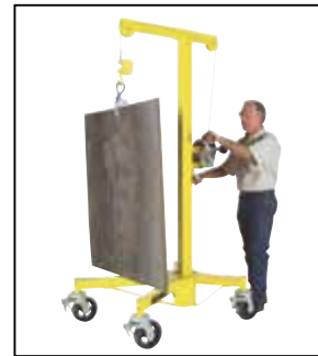
Déplacer la plaque avec la bride de serrage de levage de plaque
