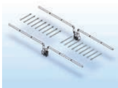
Système parallèle doublé de push/pull composé par deux filtres et deux ventilateurs.
