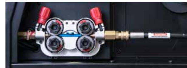
**Raccordement pour alimentation par fût (adaptateur optionnel).**
