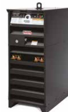
Si une application exige une puissance de soudage et la possibilité de souder en multiprocédé, la gamme IDEALARC et son courant DC lisse représentent l'investissement qu'il vous faut. Conçu pour le soudage automatique, semi-automatique et doté d'un contrôle précis, IDEALARC® offre de remarquables performances en soudage MIG, à l'arc submergé, en fils fourrés, ainsi qu'un excellent gougeage en arc air avec des électrodes carbonées dont le diamètre peut aller jusqu'à 16,0 mm.
