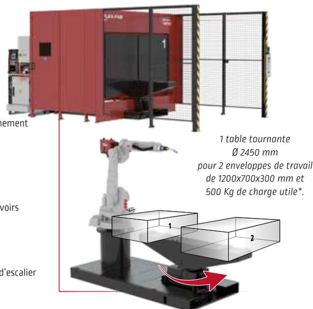
1 table tournante Ø 2450 mm pour 2 enveloppes de travail de 1200x700x300 mm et 500 Kg de charge utile\*.
