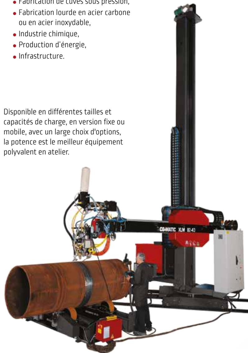
La potence associée à divers systèmes de positionnement permet le mouvement ou la rotation des pièces pour maximiser l'utilisation de l'équipement dans une large gamme d'applications.
