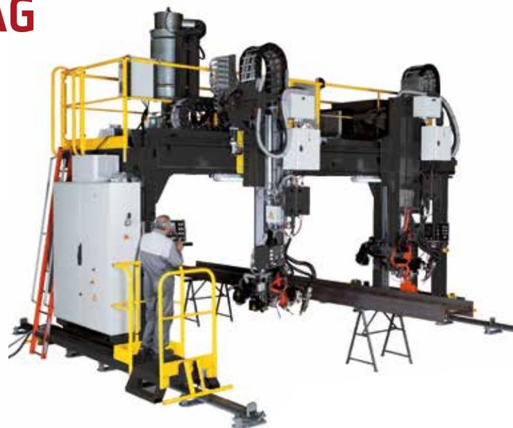
**Portique de soudage MIG/MAG aluminium** avec deux torches pour répondre à des applications nécessitant un haut niveau de productivité avec des pièces de grandes dimensions telles que la fabrication de wagons de chemin de fer.
