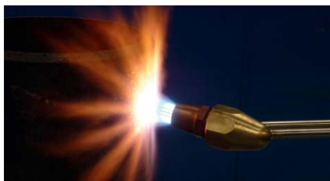
Chauffe avec buse multidard
