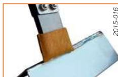
Visser la solution de décapage sur la torche puis installez le tampon ou le pinceau. Ce dernier donne un meilleur accès pour décaper les angles. Passez la torche jusqu'à ce que la pièce soit nettoyée.
