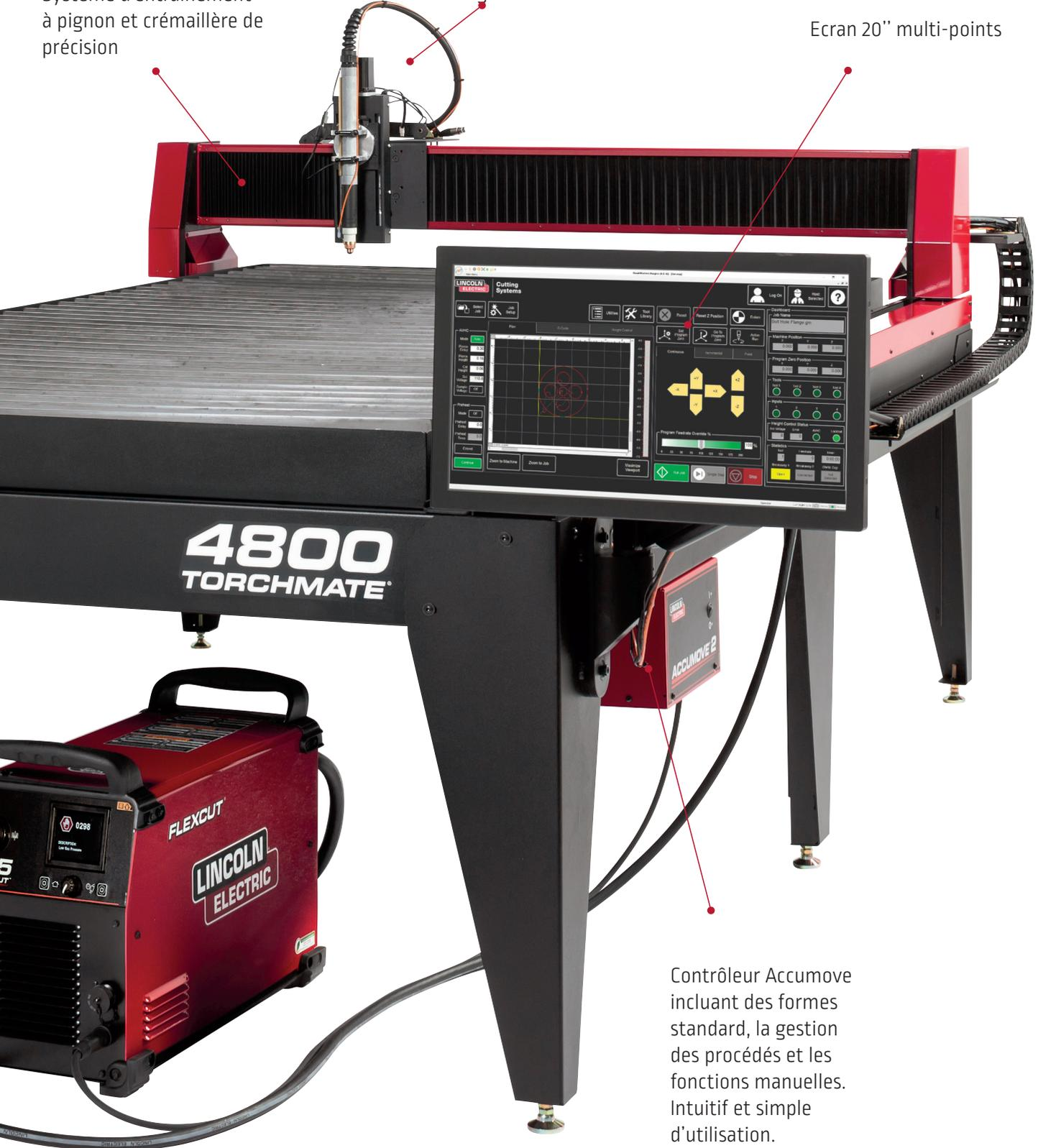
Contrôleur AccuMOVE incluant des formes standard, la gestion des procédés et les fonctions manuelles. Intuitif et simple d'utilisation.
